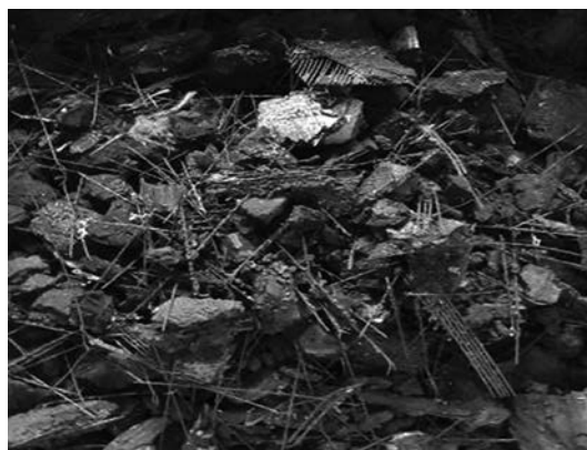
Рис. 3. Внешний вид образований сажи с металлокордом после пробных экспериментов при температуре 450 °С.
