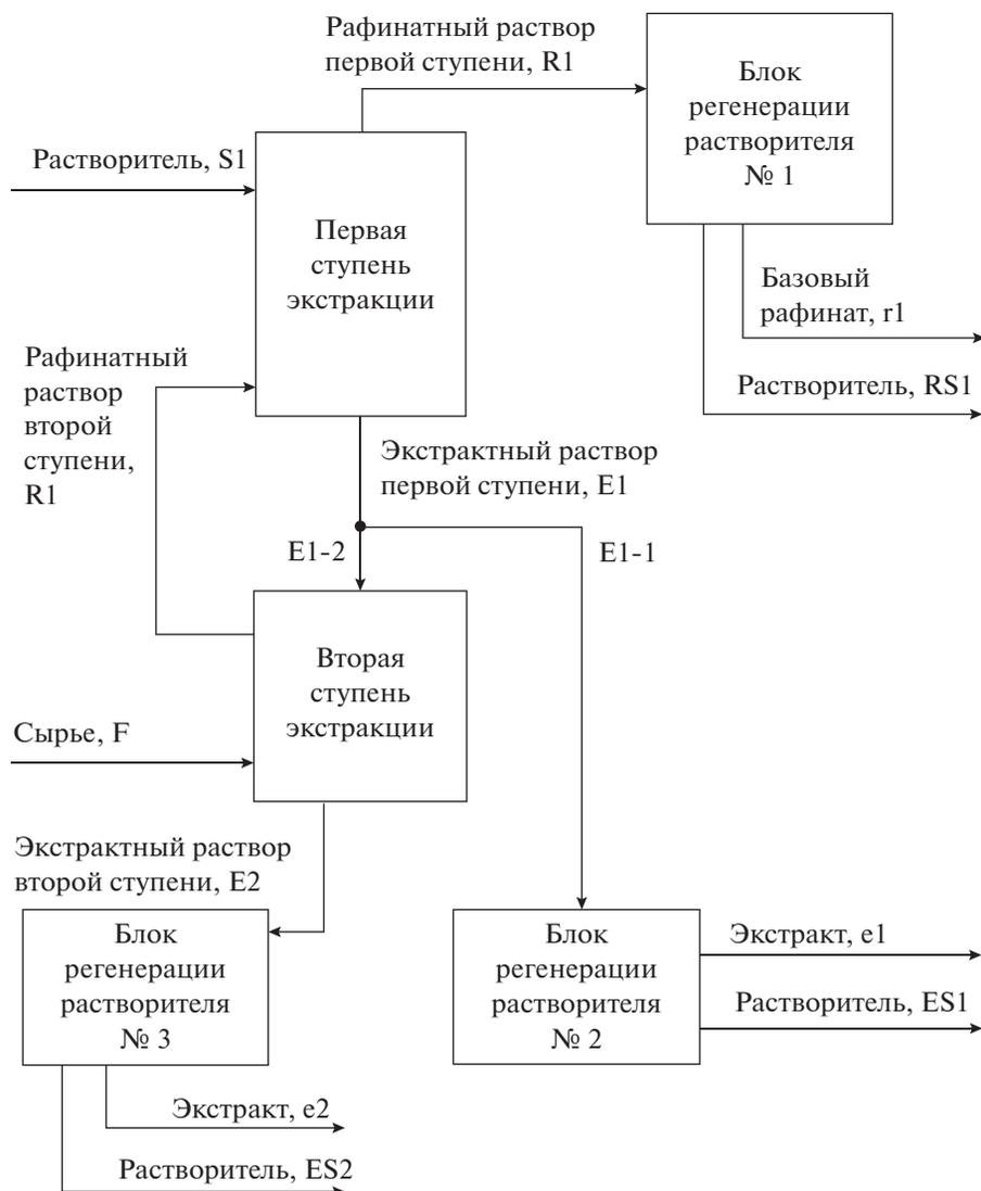
Схема 2. Двухступенчатая схема получения пластификатора.
