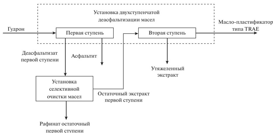
Схема 4. Схема производства масла-пластификатора типа TRAE.
