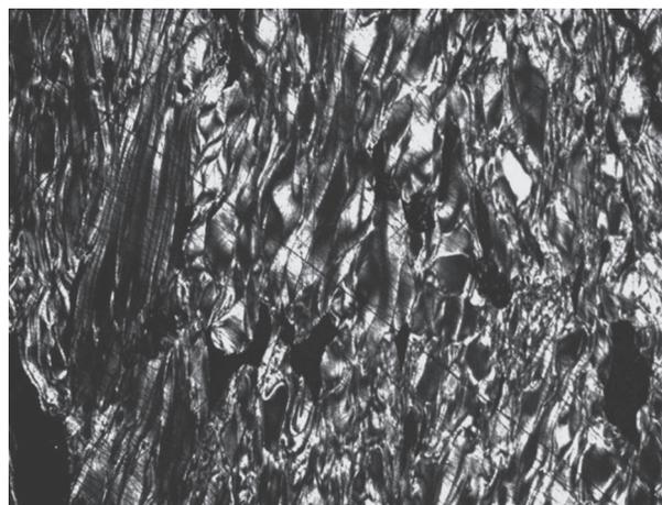
**Рис. 3.** Оптическая текстура пека из тяжелого газойля каталитического крекинга, полученного при изотермической выдержке 400 $^\circ\text{C}$  в течение 150 мин. Кратность увеличения 200.
