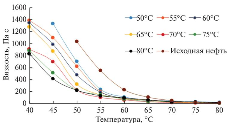
Рис. 2. Зависимость вязкости нефти от температуры ультразвуковой обработки.
