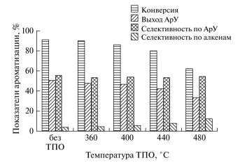
**Рис. 4.** Влияние температуры ТПО галлоалюмосиликата на основные показатели процесса ароматизации пропана ( $T_{\text{реакции}} = 550 \, ^{\circ}\text{C}$ ).
