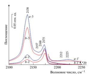
**Рис. 3.** ИК-спектры в области колебаний карбонильных групп после адсорбции 0,1 (a-1', b-1'), 1 (a-2, b-2) и 5 мбар CO (a-3, b-3) при температуре жидкого азота на образцы: a — исходный ГАС, b — ГАС после проведения ТПО при 400 °C.
