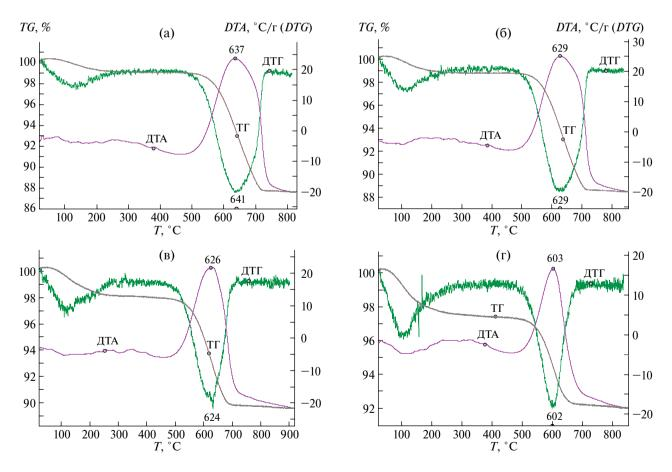
**Рис. 5.** Термограммы исходного ГАС (*a*) и ГАС после ТПО при  $360~(\delta)$ , 400~(B) и  $440~(\epsilon)$  °C, обработанных пропаном в течение  $12~\rm y$ .
