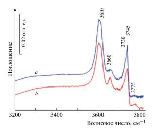
**Рис. 1**. ИК-спектры образцов в области колебаний поверхностных гидроксильных групп: a — исходный ГАС, b — ГАС после проведения ТПО при 400 °C.
