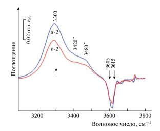
**Рис. 2.** Разностные ИК-спектры после адсорбции СО ( $P_{CO}$  1 мбар) при температуре жидкого азота на образцы: a — исходный ГАС, b — ГАС после проведения ТПО при 400 °C.
