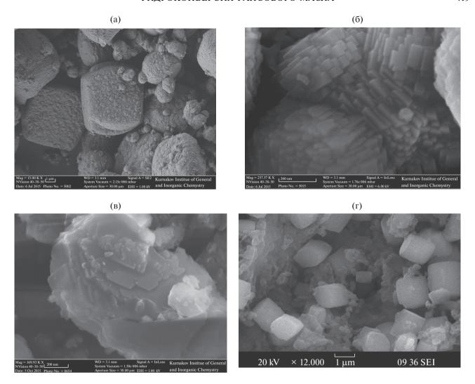
РЭМ-микрофотографии цеолита MFI (а, б), цеолита MFI, промотированного 2 мас. % Zn (в) и композита MFI/MCM-41 (г), синтезированных гидротермально-микроволновым методом.
