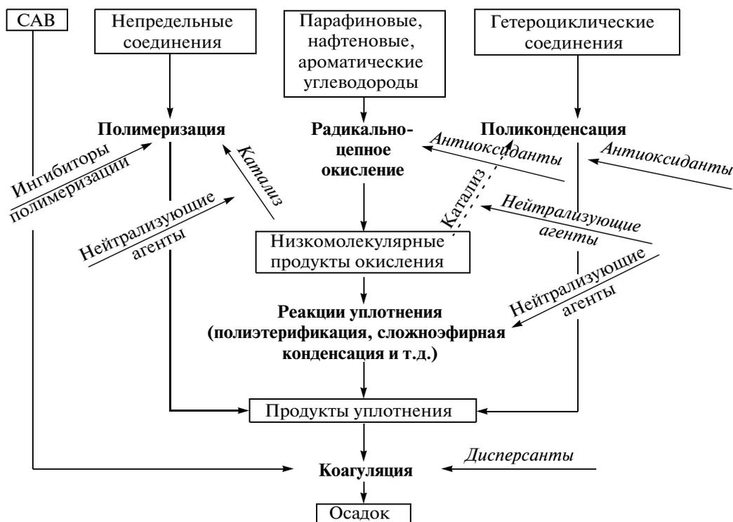
**Схема.** Упрощенная схема образования смол и осадка в топливах и действие стабилизаторов (выделены курсивом). Комплекс превращений, ответственных за старение топлива.
