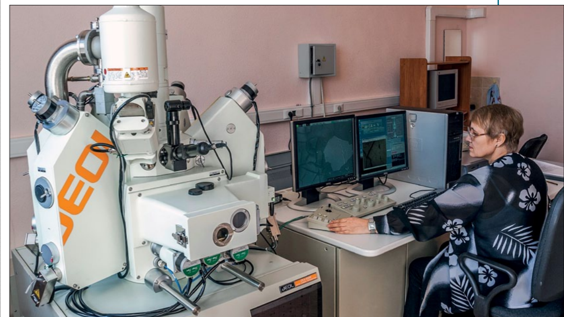
Новые приборы, которыми в последнее время наполняются институтские лаборатории, это как пропуск в мир иных возможностей. Рентгено-спектральный электронно-спектральный микроанализатор JXA8200, который изображен на снимке, может применяться в минералогии, материаловедении, в изучении поверхности твердых объектов, в исследовании функциональных наноматериалов
