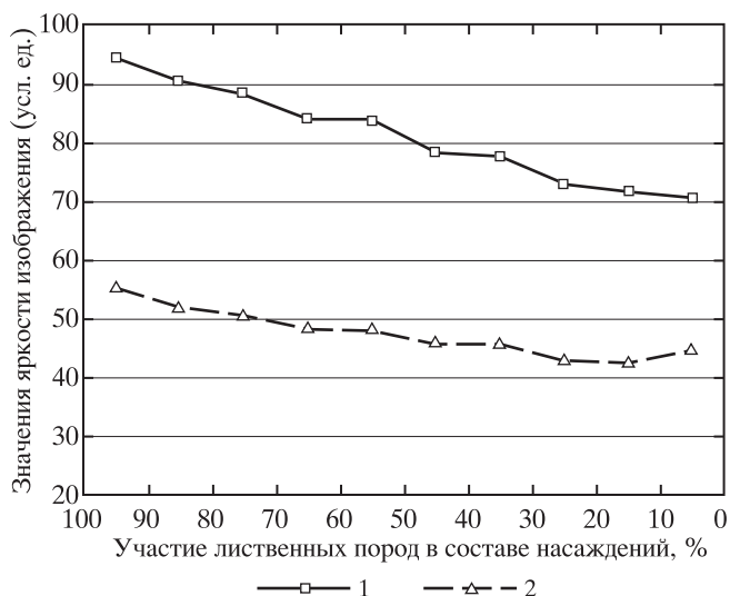
Рис. 4. Связь яркости изображений в NIR (1) и SWIR1 (2) каналах с участием лиственных пород в составе насаждения
