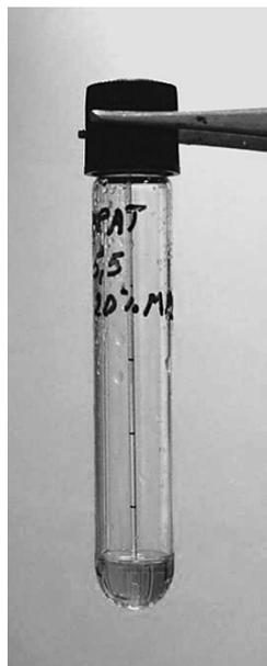
**Рис. 2.** GT-метод кристаллизации: капилляр с надетой на него гелевой трубкой в пробирке с раствором осадителя.
