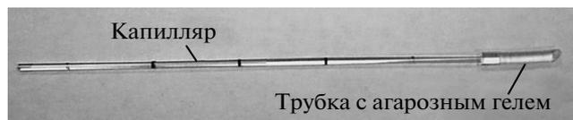
**Рис. 1.** Капилляр с раствором белка и с присоединенной к капилляру силиконовой трубкой, заполненной агарозным гелем.
