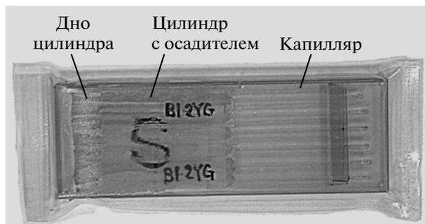
**Рис. 3.** Кристаллизационный бокс JAXA (JCB): шесть капилляров уложены в бокс, помещенный в герметизированный пластиковый пакет.
