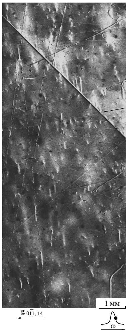
Рис. 3. Двухкристальная рентгеновская топограмма подложки из сапфира ориентации (01\bar{1}2) (образец № 3) после химико-механической полировки с полностью удаленным нарушенным слоем. Отражение 01\bar{1}, 14 , \omega_B геометрия дифракции, \text{CuK}\alpha_1 -излучение, монохроматор \text{Ge}_{620} , экспозиция 20 мин. Показана проекция вектора дифракции на плоскость топограммы. Точкой отмечено угловое положение образца в процессе экспозиции.
