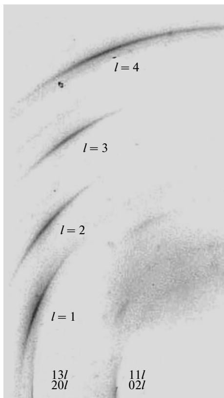
Рис. 5 .Фрагмент электронограммы кривой текстуры (электронограф ЭГ-400, ускоряющее напряжение 350 кВ, угол наклона препарата \varphi = 60^\circ ) образца лизардита 1T с проявлением в интенсивностях рефлексов 20l , 13l дефектов укладки слоев, связанных со смещением слоев на a/3 .
