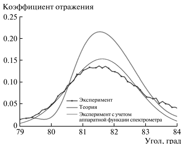
Рис. 4. Экспериментальный и вычисленный коэффициенты отражения Cr/C-зеркала при \lambda = 4.478 нм.
