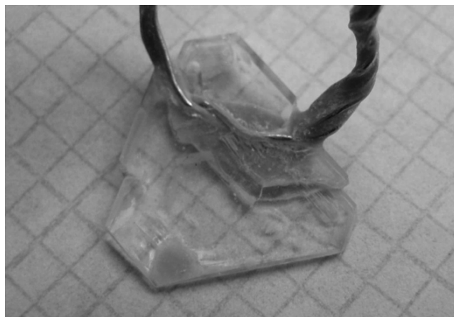
Рис. 5. Фотография спонтанных кристаллов \text{NaBaY}(\text{BO}_3)_2 . Размер клеток – 2.5 \times 2.5 \text{ мм}^2 .
