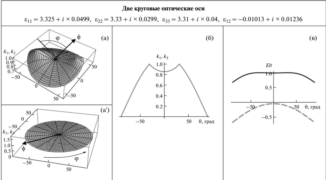
**Рис. 4.** Зависимость  $k_1, k_2$  от углов  $\phi$  и  $\phi$  (а, а') и от угла поворота  $\theta$  вокруг оси  $X$  в плоскости, содержащей две круговые оптические оси (б); зависимость эллиптичностей прошедшего света  $EIt$  от угла  $\theta$  (в); толщина кристалла  $d = 10$  мкм.
