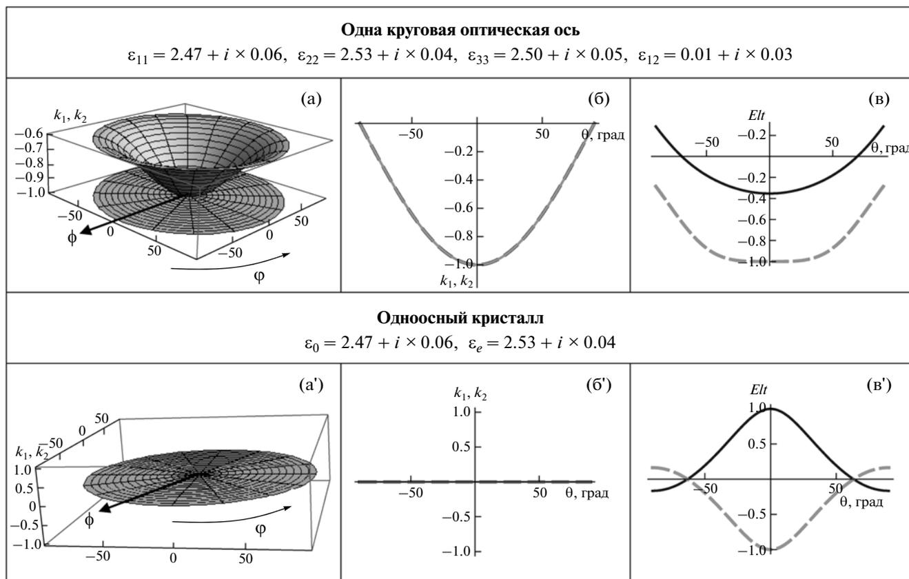
**Рис. 1.** Зависимость  $k_1, k_2$  от углов  $\phi$  и  $\theta$  (а, а') и от угла  $\theta$  (б, б'), зависимость эллиптичности прошедшего света  $Elt$  от угла  $\theta$  (в, в'); толщина кристалла  $d = 10$  мкм.
