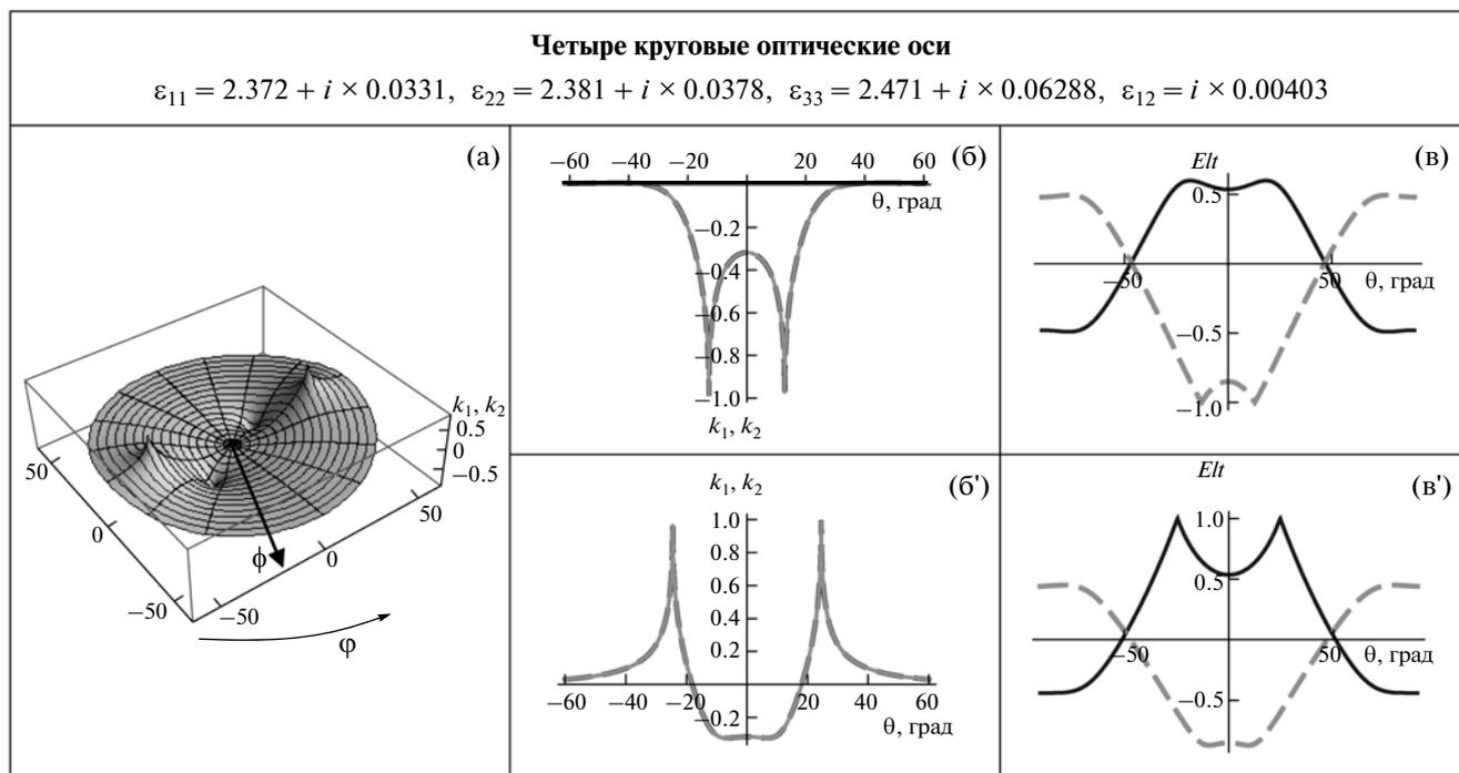
**Рис. 6.** Зависимость  $k_1, k_2$  от углов  $\phi$  и  $\theta$  (а) и от угла поворота  $\theta$  вокруг оси  $X$  в двух плоскостях, содержащих сопряженные круговые оптические оси (б, б'); зависимость эллиптичностей прошедшего света  $Elt$  от угла  $\theta$  (в, в'); толщина кристалла  $d = 10$  мкм.
