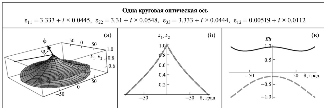
**Рис. 2.** Зависимость  $k_1, k_2$  от углов  $\phi$  и  $\theta$  (а) и от угла поворота  $\theta$  вокруг оси  $X$  в плоскости, содержащей круговую и изотропную оптические оси (б); зависимость эллиптичностей прошедшего света  $Ell$  от угла  $\theta$  (в); толщина кристалла  $d = 10$  мкм.
