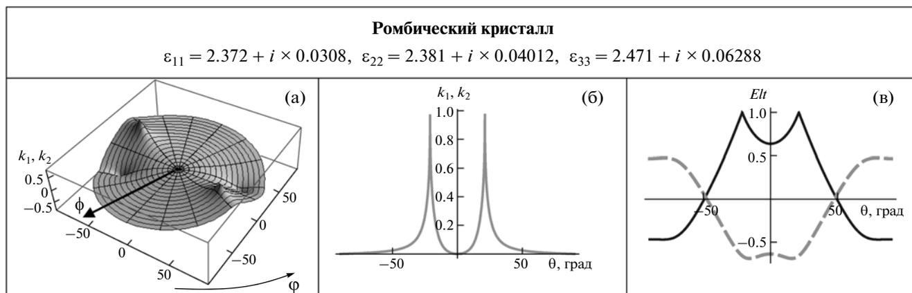
**Рис. 7.** Зависимость  $k_1, k_2$  от углов  $\phi$  и  $\varphi$  (а) и от угла поворота  $\theta$  вокруг оси  $X$  в одной из плоскостей, проходящих через сопряженные оптические оси (б); зависимость эллиптичностей прошедшего света  $Elt$  от угла  $\theta$  (в); толщина кристалла  $d = 10$  мкм.
