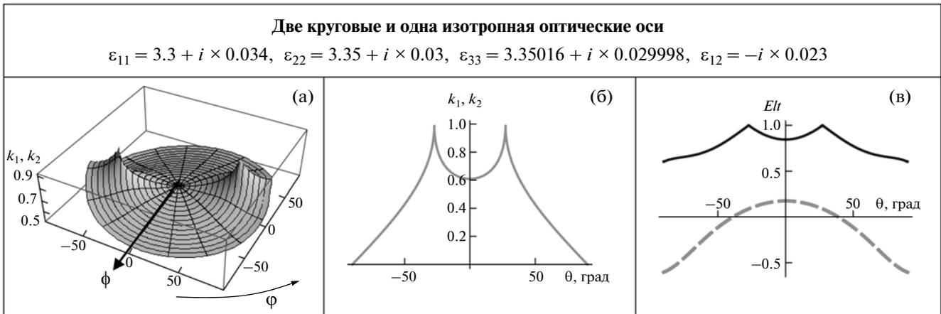
**Рис. 5.** Зависимость  $k_1, k_2$  от углов  $\phi$  и  $\phi$  (а) и от угла поворота  $\theta$  вокруг оси  $X$  в плоскости, содержащей две круговые оптические оси (б); зависимость эллиптичностей прошедшего света  $EIt$  от угла  $\theta$  (в); толщина кристалла  $d = 10$  мкм.
