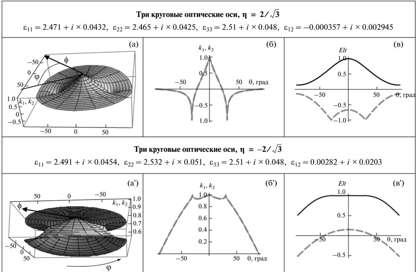
**Рис. 3.** Зависимость  $k_1, k_2$  от углов  $\phi$  и  $\varphi$  (а, а') и от угла поворота  $\theta$  вокруг оси  $X$  в плоскости, содержащей три круговые оптические оси (б, б'); зависимость эллиптичностей прошедшего света  $Elt$  от угла  $\theta$  (в, в'); толщина кристалла  $d = 10$  мкм.
