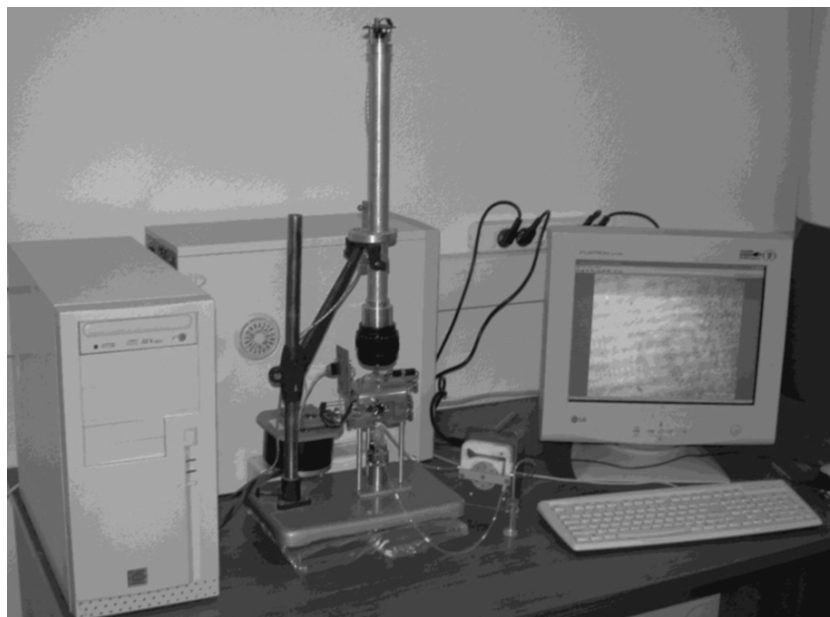
Рис. 2. Система для исследования роста кристаллов методом лазерной интерферометрии: 1 – кристаллизационная ячейка, 2 – интерферометр, 3 – объектив, 4 – CCD-камера, 5 – перистальтический насос.
