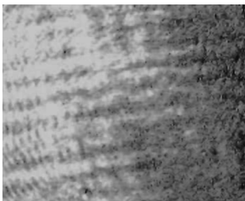
Рис. 3. Интерференционная картина поверхности растущего кристалла тетрагонального лизоцима (прямые полосы – отражение от стекла ячейки).
