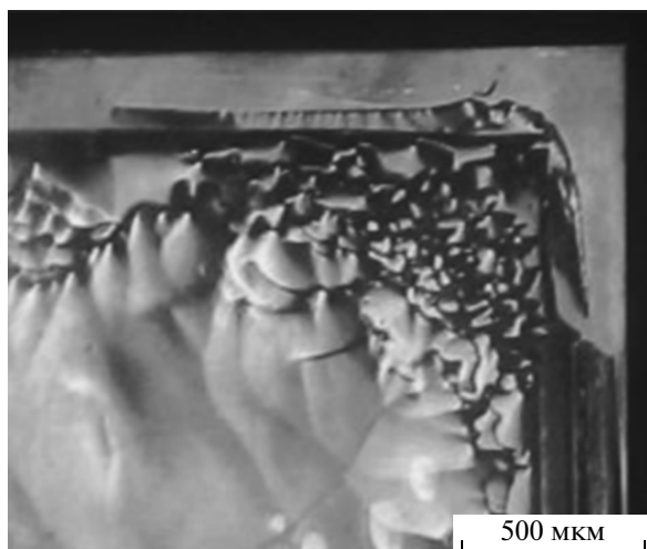
Рис. 3. Морфология грани куба \text{NH}_4\text{Cl} в растворе с примесью формамида – фото in situ в микрокристаллизационной кювете, \Delta t = 5^\circ\text{C} .
