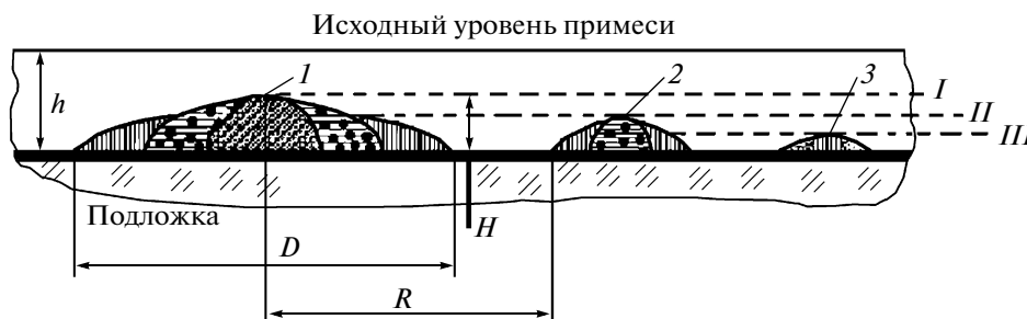
Рис. 3. Схематическое изображение роста зародышевых образований на различных этапах процесса.
