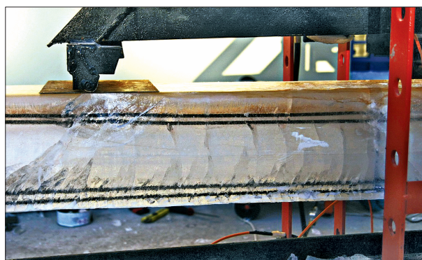
Рис. 3. Появление трещин в ледяной балке.
