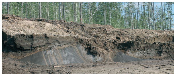
Рис. 2. Фрагмент обширного обнажения полигонально-жильных льдов на участке реконструкции АЯМ в 2011 г. в районе пос. Качикатцы.
