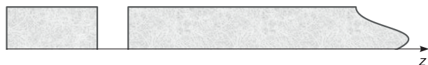
Рис. 13. Система из двух блоков льда, разделенных промежутком, второй блок льда бесконечной длины.
