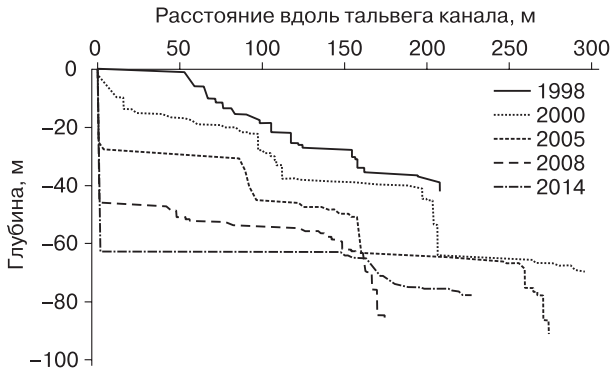
Рис. 5. Продольные профили внутриледного канала ледника Брёггер разновременных топографических съемок.
