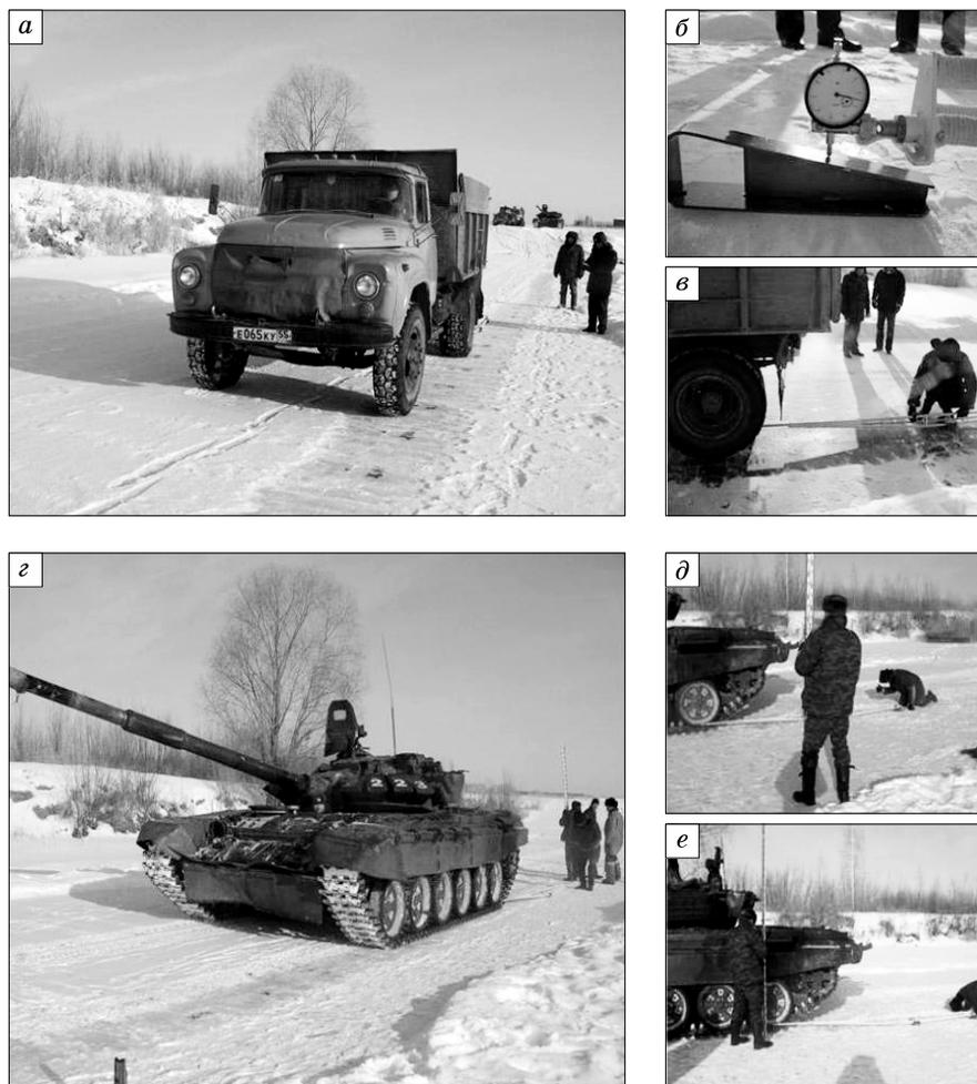
Рис. 6. Испытание опытного участка колесной (а-в) и гусеничной (г-е) техникой.
