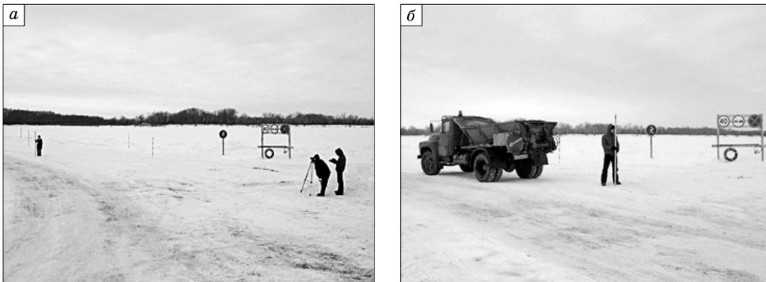
**Рис. 13. Испытания – измерение упругого прогиба ледяной плиты до нагружения (*a*), под действием нагрузки (*б*).**
