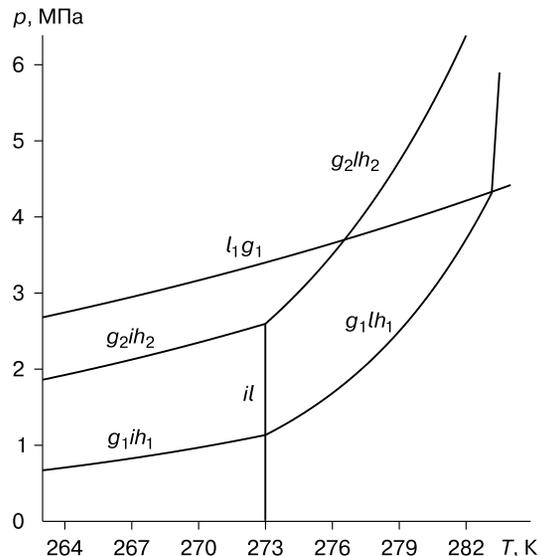
Рис. 2. Фазовые диаграммы систем  $\text{CO}_2\text{-H}_2\text{O}$  и  $\text{CH}_4\text{-H}_2\text{O}$ .
