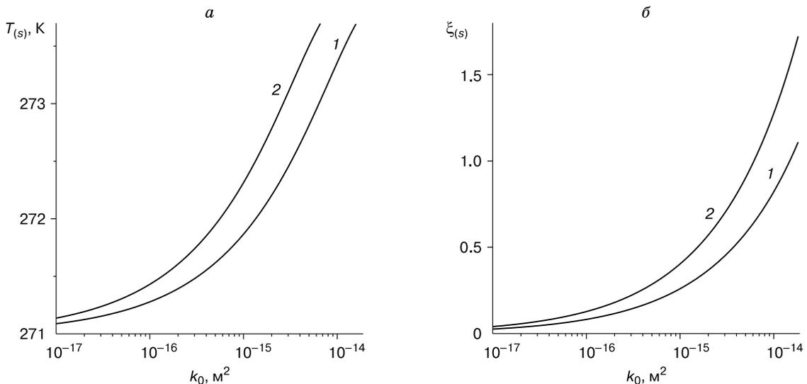
**Рис. 7. Зависимость температуры  $T_{(s)}$  на границе фазовых переходов (а) и автомодельной координаты  $\xi_{(s)}$  данной границы (б) от абсолютной проницаемости  $k_0$  при разных значениях давления закачиваемого газа:**
