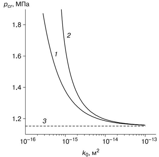
**Рис. 6. Зависимость предельного значения давления нагнетаемого газа  $p_{cr}$  от абсолютной проницаемости пласта  $k_0$ .**
