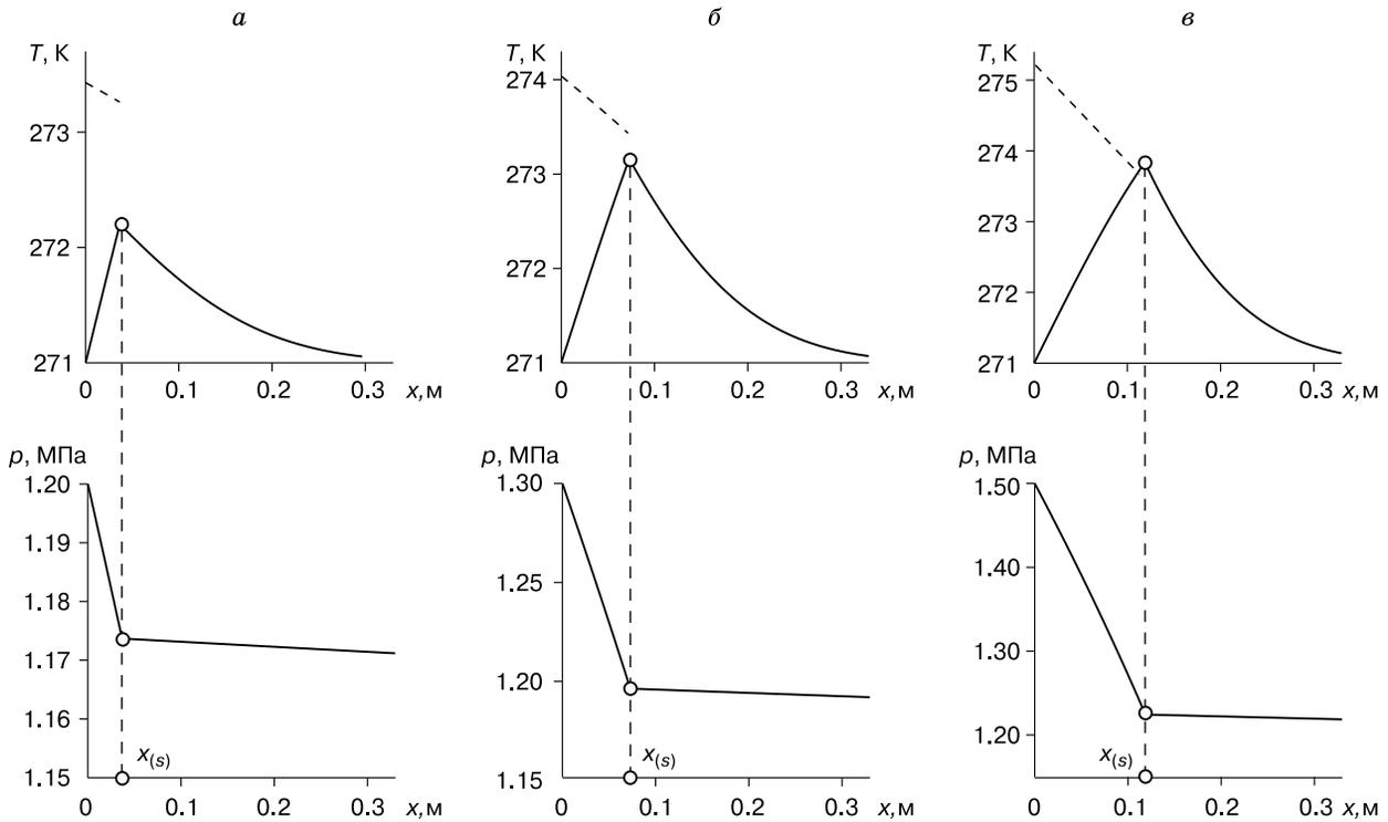
**Рис. 3. Изменение по пространственной координате  $x$  температуры  $T$  и давления  $p$  в пласте при разных значениях давления нагнетания диоксида углерода:**
