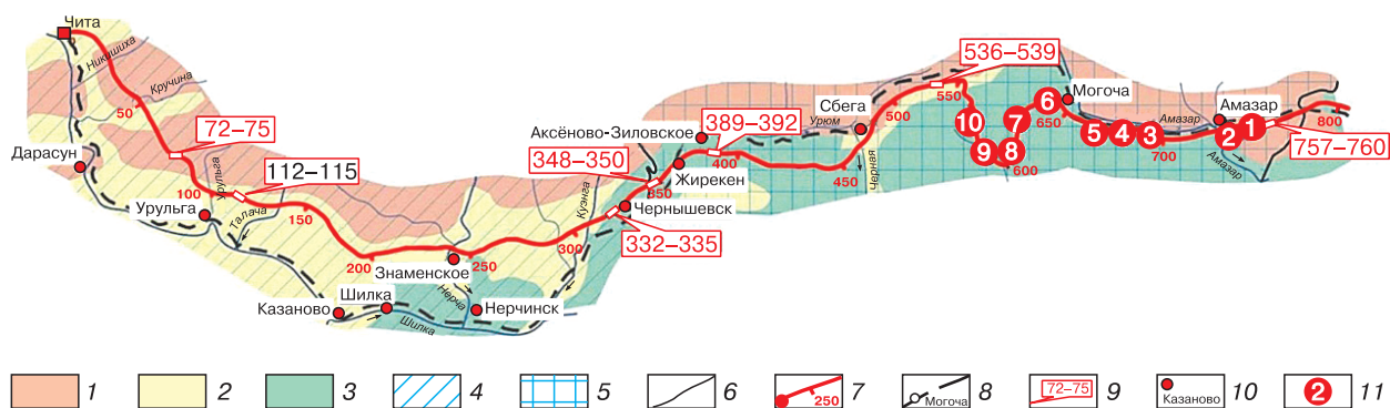
Рис. 1. Обзорная схема мерзлотно-геоморфологического районирования территории Забайкальского края в полосе трассы федеральной автодороги “Амур” [Кондратьев и др., 2010].
