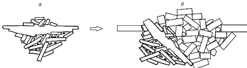
**Рис. 5. Одна из возможных схем образования вторичного тороса.**
