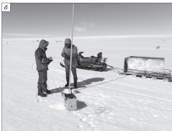
Рис. 3. Фотографии сломанной вехи (а) и процесса измерения планового положения и высоты вех (б). Фотографии С.В. Попова (а) и А.Л. Новикова (б), февраль 2017 г.
