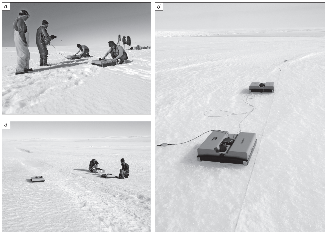
Рис. 6. Выполнение наклонных зондирований по системе ОГТ.
