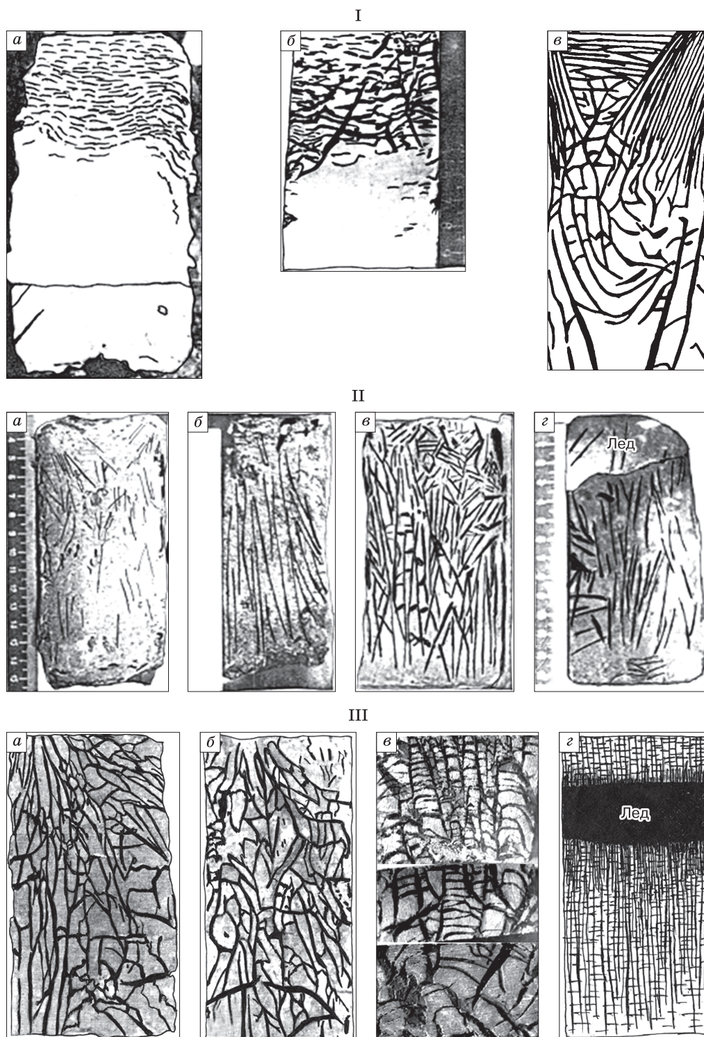
Рис. 6. Криогенное строение грунта различного вещественного состава при разной начальной весовой влажности:
