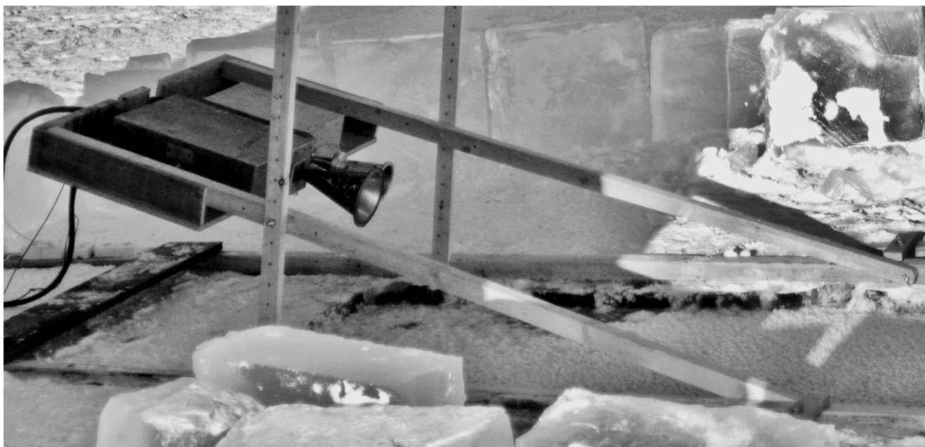
Рис. 5. Фотография установки для измерения мощности теплового излучения льда на проруби на длины волн 0.88 см и 2.3 см.
