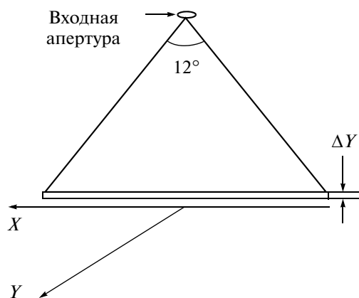
Рис. 2. Полоска поверхности Земли, проецируемая на вход электроннооптического усилителя. Величина полосы по Y определяется углом 1' и высотой полета.
