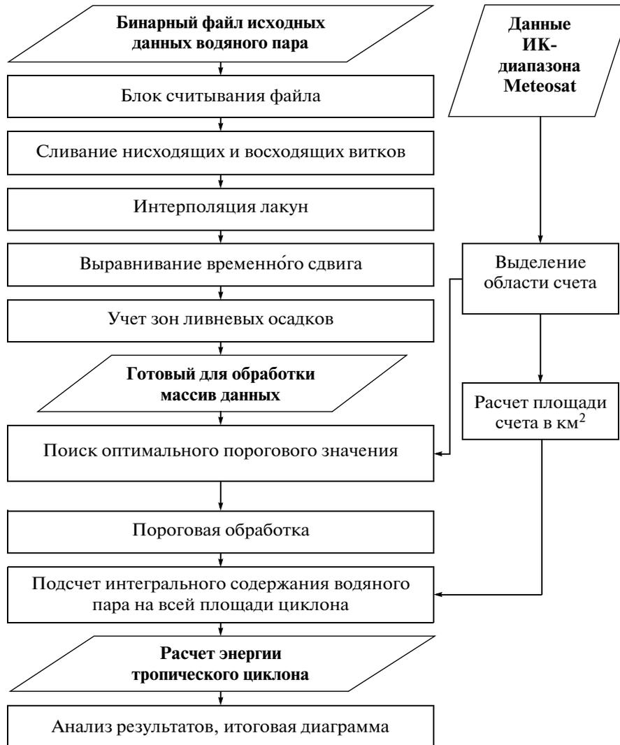
Рис. 2. Блок-схема алгоритма обработки данных.
