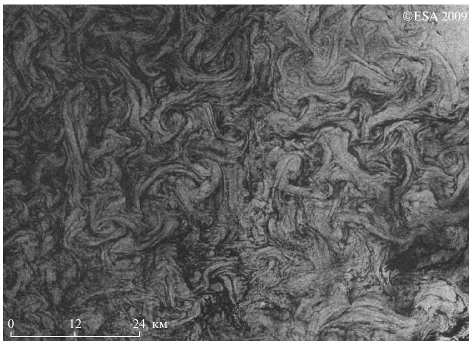
Рис. 1. Область субмезомасштабной завихренности поля поверхностных течений в Балтийском море. Envisat ASAR WSM, 25.04.2009 г. 09:09 GMT. Пространственное разрешение 150 м.
