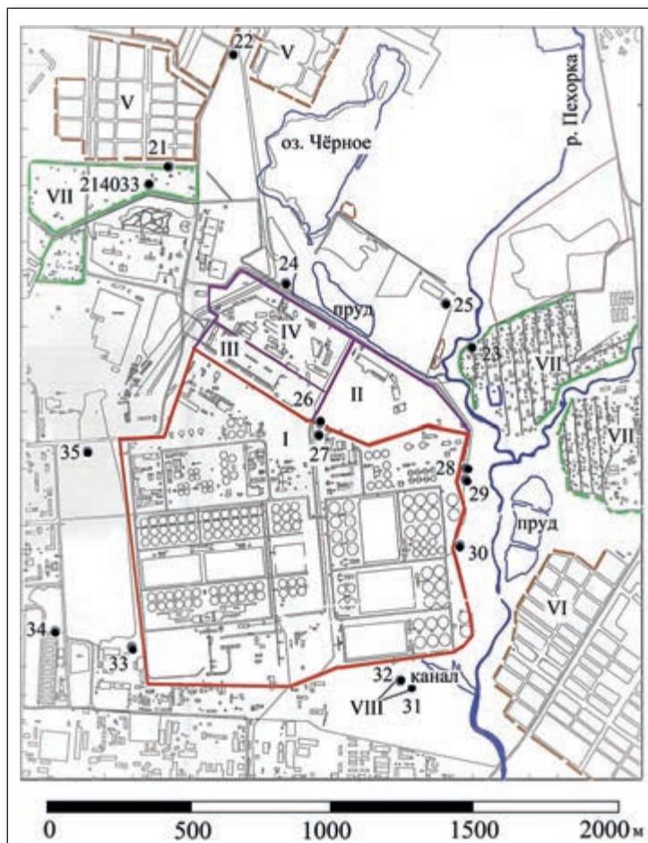
Рис. 1. Ситуационный план: I — ЛОС, II — завод по производству гипохлорита натрия, III — завод «МосИнжБетон», IV — площадка «Вторчермет», V — отстойники, VI — площадки складирования илового осадка сточных вод, VII — дачные участки, VIII — наблюдательные скважины
