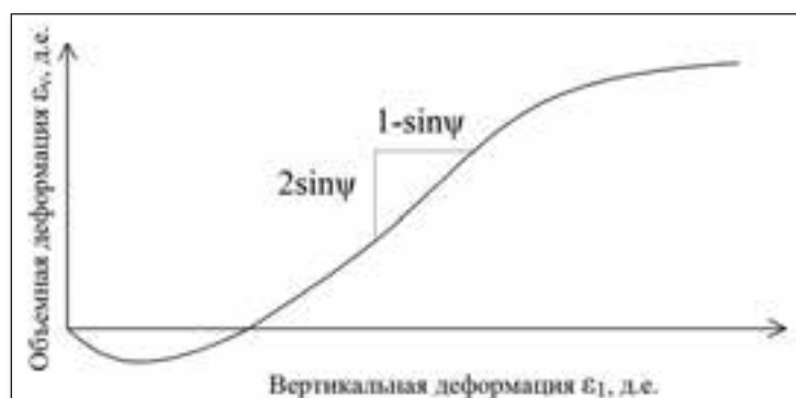
Рис. 6. Общий вид зависимости объемной деформации от вертикальной для трехосного сжатия, участок наибольшего наклона используется для определения угла дилатансии
