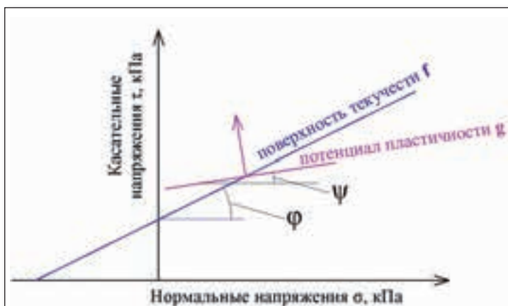
Рис. 3. Положение поверхности текучести (f) и пластического потенциала (g)
