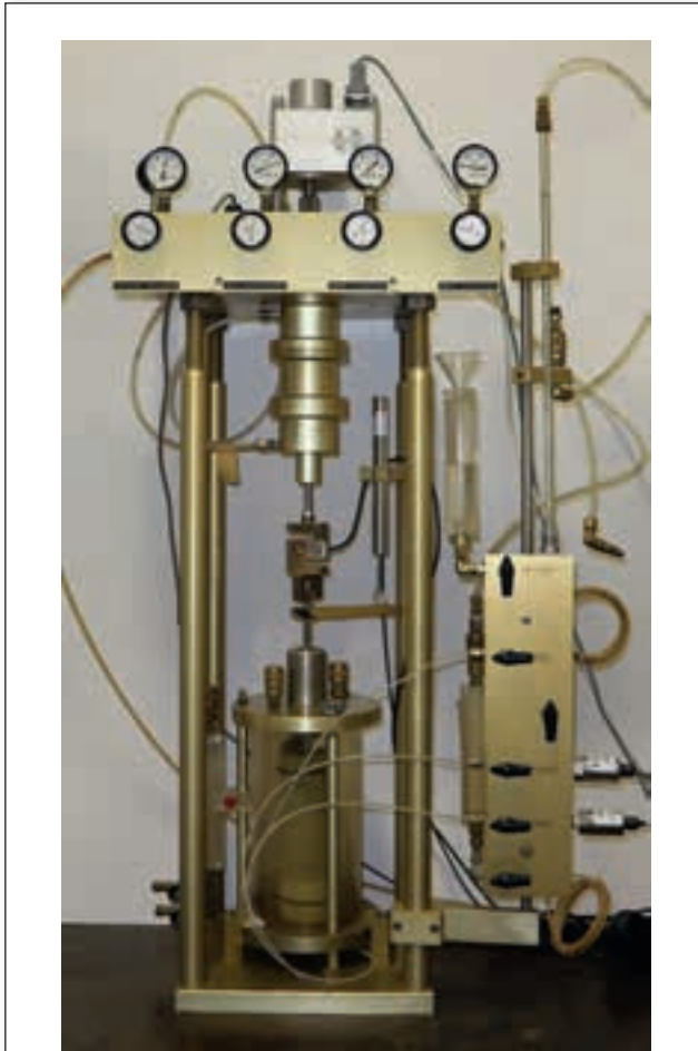
Рис. 3. Прибор динамического трехосного сжатия Geotechnical Instruments (Канада) с дополнительным кинематическим приводом ООО «НПП «Геотек»» (Россия)
