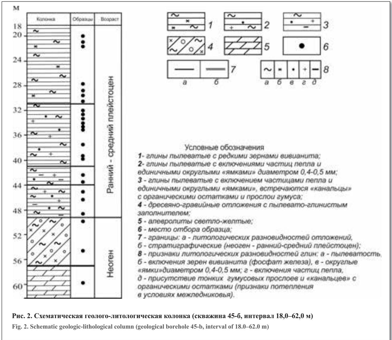
Рис. 2. Схематическая геолого-литологическая колонка (скважина 45-б, интервал 18,0–62,0 м)
