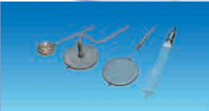
Датчики грунтового давления
