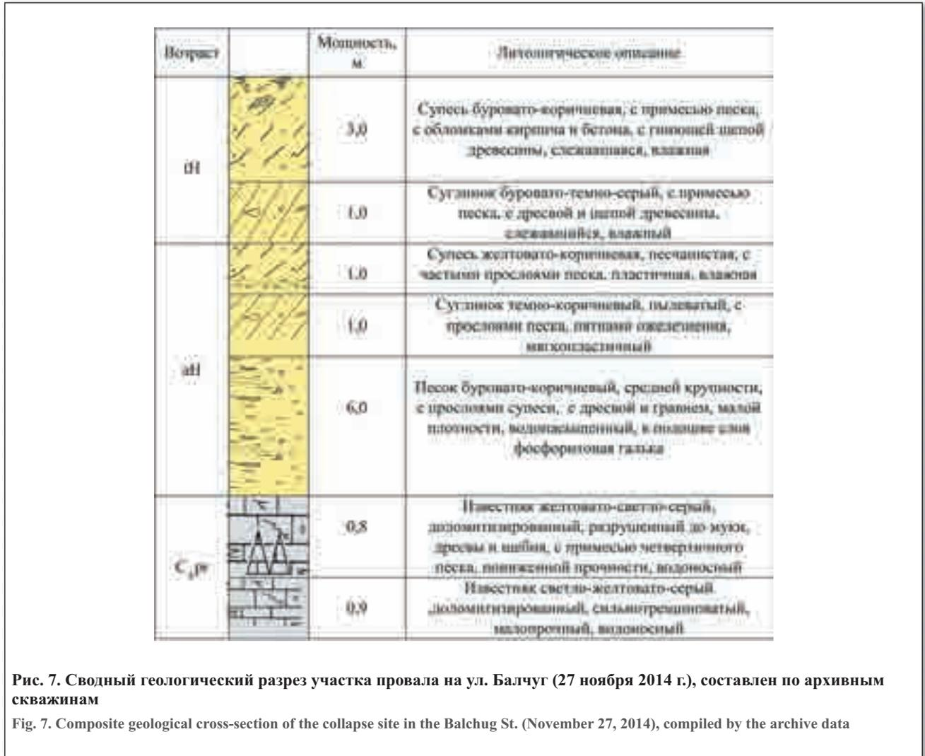
Рис. 7. Сводный геологический разрез участка провала на ул. Балчуг (27 ноября 2014 г.), составлен по архивным скважинам
