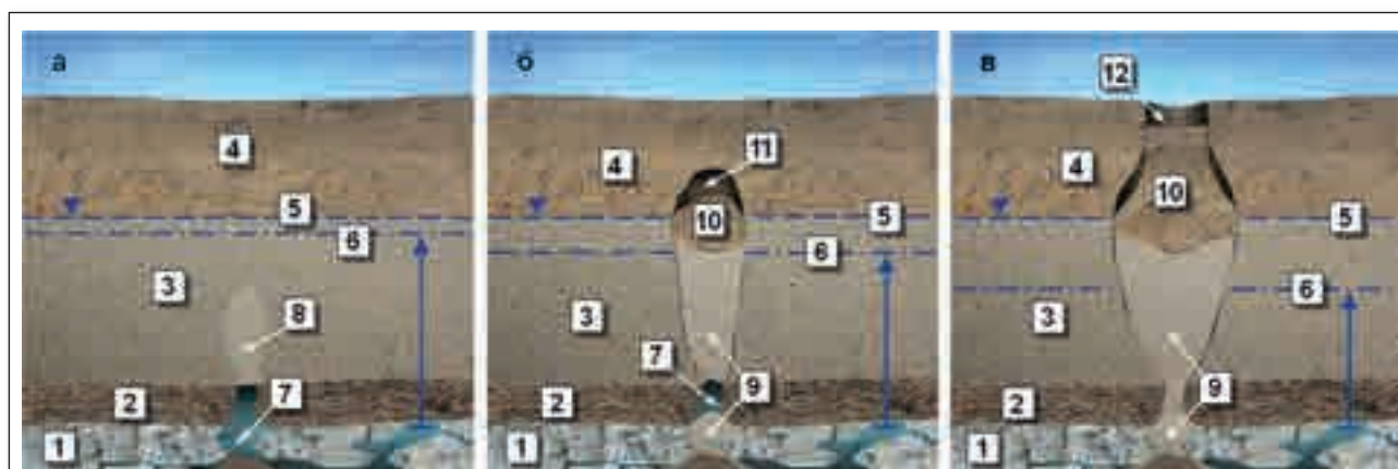
Рис. 2. Схема, иллюстрирующая механизм формирования карстово-суффозионного провала фреатического типа, вызванного оттоком воды из растворимых пород: 1 — растворимые породы; 2 — глинистые грунты; 3 — несвязные грунты; 4 — несвязные и (или) связные дисперсные грунты; 5 — уровень надкарстовых вод; 6 — пьезометрический уровень карстовых вод; 7 — полость, заполненная водой; 8 — зона суффозионного разрушения; 9 — грунты, разрушенные суффозией и испытавшие нисходящее перемещение; 10 — грунты, испытавшие обрушение; 11 — полость, не заполненная водой; 12 — провал
