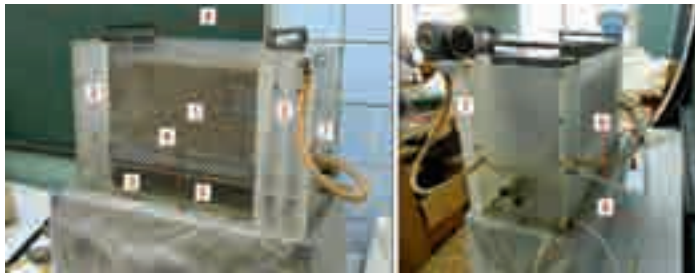
Рис. 9. Экспериментальное оборудование, предназначенное для моделирования суффозионных процессов: 1 — рабочая камера, частично заполненная материалом модели; 2 — боковые камеры, заполняемые водой; 3 — нижняя камера, имитирующая карстовую полость-приемник; 4 — водопроницаемые перегородки, отделяющие боковые камеры от рабочей; 5 — дно рабочей камеры; 6 — прорезь, имитирующая карстовый канал; 7 — перепускная трубка; 8 — трубки, соединяющие боковые камеры; 9 — дренажные трубки нижней камеры
