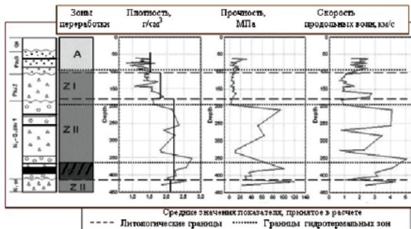
Рис. 2. Изменчивость свойств по разрезу Паужетской ГТС для одной из скважин А – зона аргиллизациии, Z I – зона интенсивной цеолитизации, Z II – зона слабой цеолитизации, P – зона пропилизации
