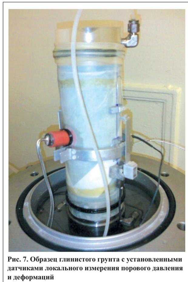
Рис. 7. Образец глинистого грунта с установленными датчиками локального измерения порового давления и деформаций
