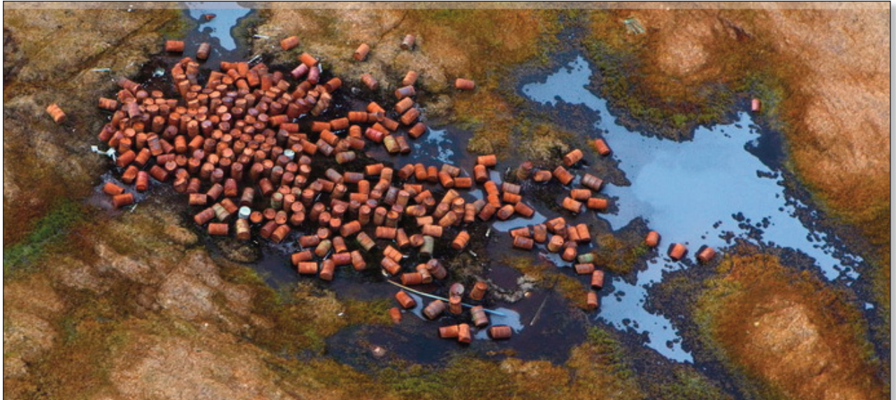
Рис. 4. Скопление бочек из-под горючего на острове Белый и пролившееся горючее, которое постепенно загрязняет территорию, распространяясь по поверхности острова и по подошве сезонно-талого слоя (фото Г. Шпикалова)
