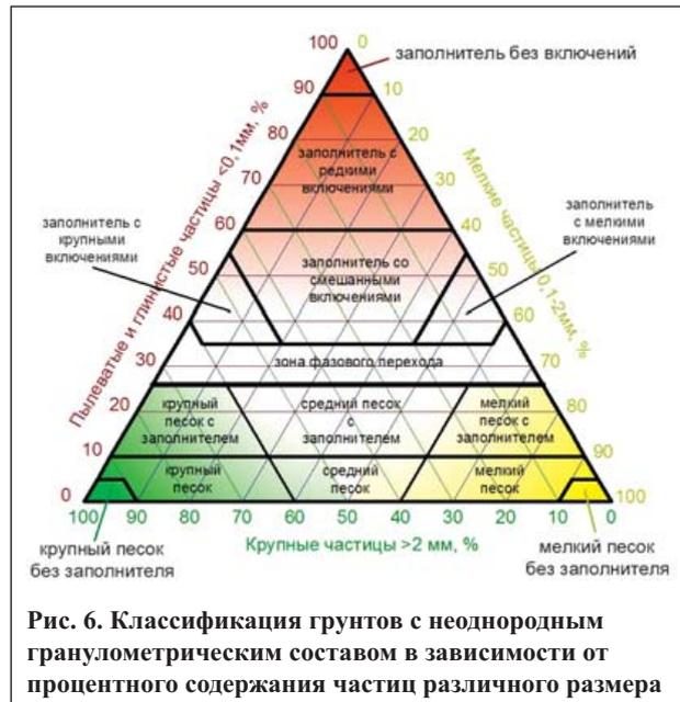
Рис. 6. Классификация грунтов с неоднородным гранулометрическим составом в зависимости от процентного содержания частиц различного размера
