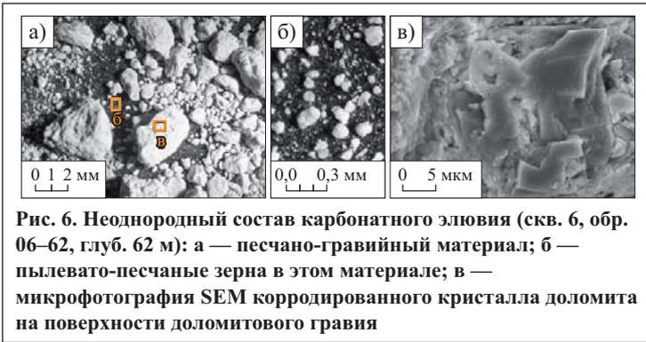
Рис. 6. Неоднородный состав карбонатного элювия (скв. 6, обр. 06–62, глуб. 62 м): а — песчано-гравийный материал; б — пылевато-песчаные зерна в этом материале; в — микрофотография SEM корродированного кристалла доломита на поверхности доломитового гравия
