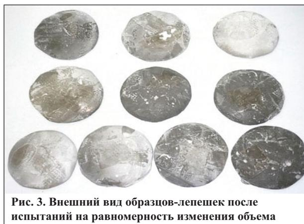
Рис. 3. Внешний вид образцов-лепешек после испытаний на равномерность изменения объема
