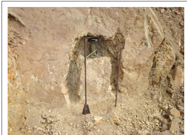
Рис. 3. Определение физико-механических свойств горных пород методом обрушения призм в натуральных условиях
