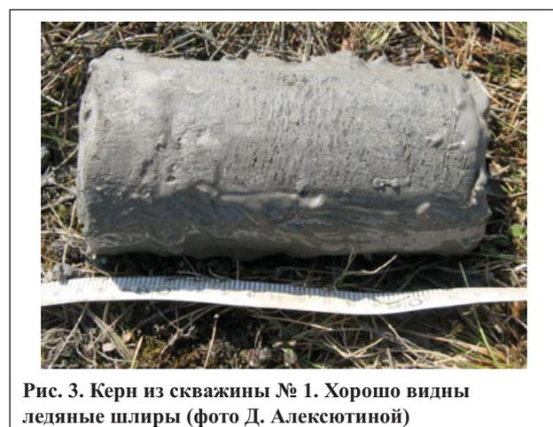
Рис. 3. Керн из скважины № 1. Хорошо видны ледяные шлиры (фото Д. Алексютиной)
