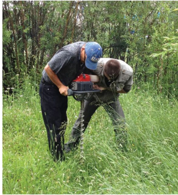
Рис. 23. Бурение скважины для установки мерзлотомера Данилина в мерзлых толщах на южном пределе их распространения в районе поселка Беркакит в юго-восточной части Средней Сибири (фото К. Йошикавы, июль 2012 г.)
