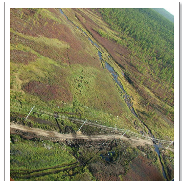
Рис. 15. Многолетние миграционные торфяные бугры пучения в долине реки Аччыгый-Леглегер в 20 км южнее стационара Керак. На ближнем плане — трасса ВСТО-1, притрассовая дорога и срезанный торфяной бугор пучения (фото М. Разумец, август 2011 г.)
