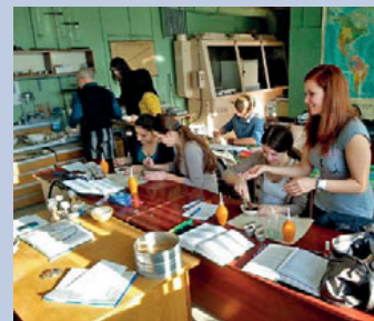
Определение физических свойств грунтов в учебной лаборатории.
