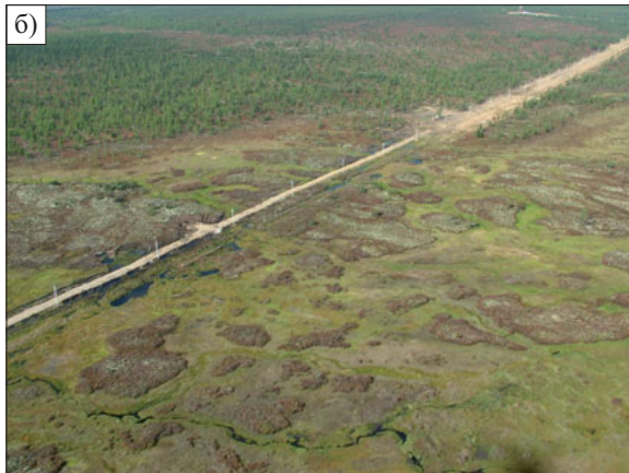
Рис. 14. Быстрое протаивание многолетнемерзлых грунтов и миграционных бугров пучения в долине ручья Озерный в 10 км южнее стационара Керак (Южная Якутия) вдоль трассы нефтепровода ВСТО-1: а — август 2010 г. (фото Ю.В. Станиловской), б — август 2011 г. (фото М. Разумец)
